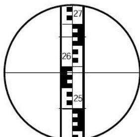
8. Определите расстояние от прибора до рейки
