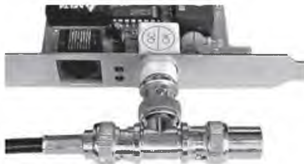
Рис. 2. Т-коннектор, присоединенный к сетевой карте
