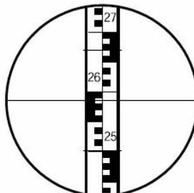
8. Определите расстояние от прибора до рейки
