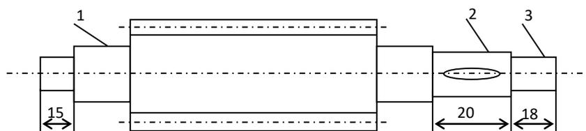
Дефект № 1 - износ поверхности под шарикоподшипник
